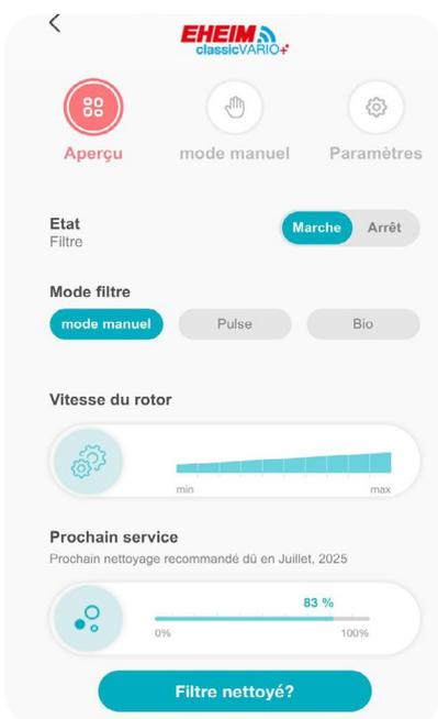
Écran de l'application indiquant le débit de la pompe (vitesse du rotor) et le taux d'encrassement pour le nettoyage
