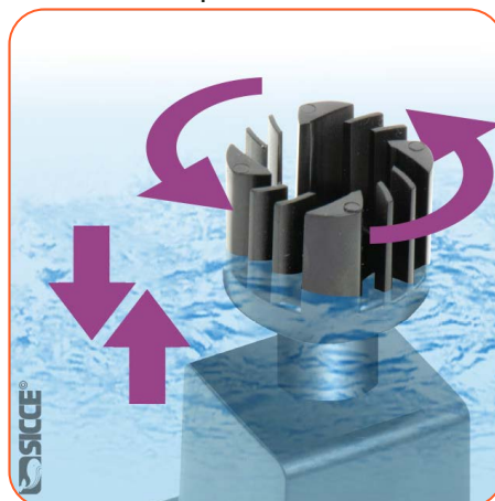
Mouvement vertical du collecteur en fonction de la hauteur d'eau et rotation liée aux particules collectées
