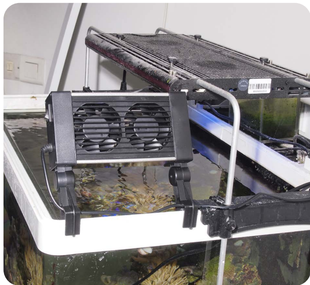
Les ventilateurs font baisser la température de l'eau
