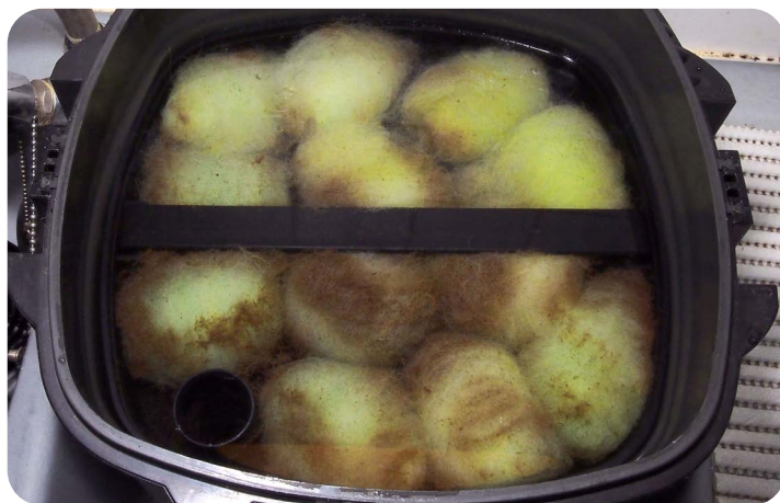
Les médias de filtration sont nettoyés juste avant la canicule pour réduire la consommation de dioxygène par les bactéries
